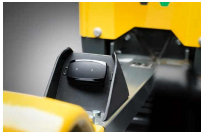
Spínač je připevněn k oji a je pro obsluhu snadno dostupný.
